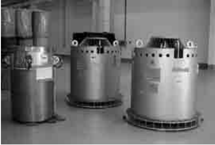
Blindaje para transportar internacionalmente fuentes industriales de cobalto 60
